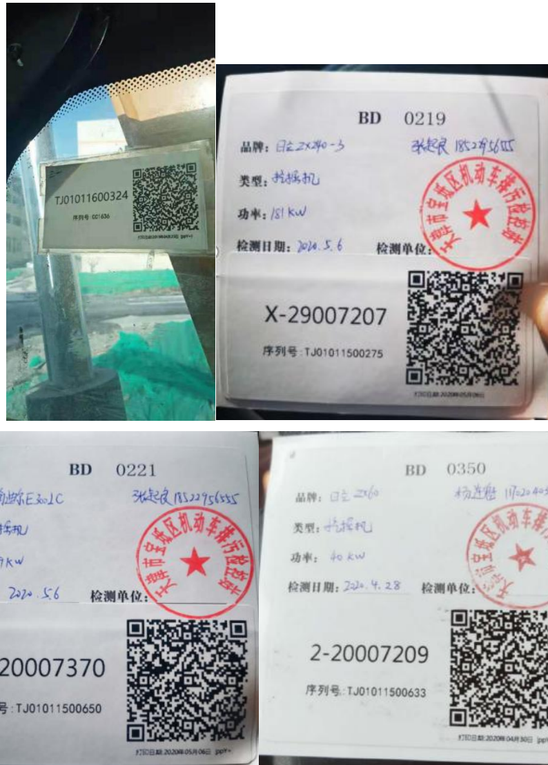
图 4-16 施工机械定期检验合格标志
