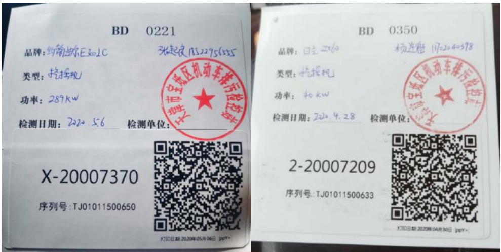
图 7-5 施工机械定期检验合格标志
