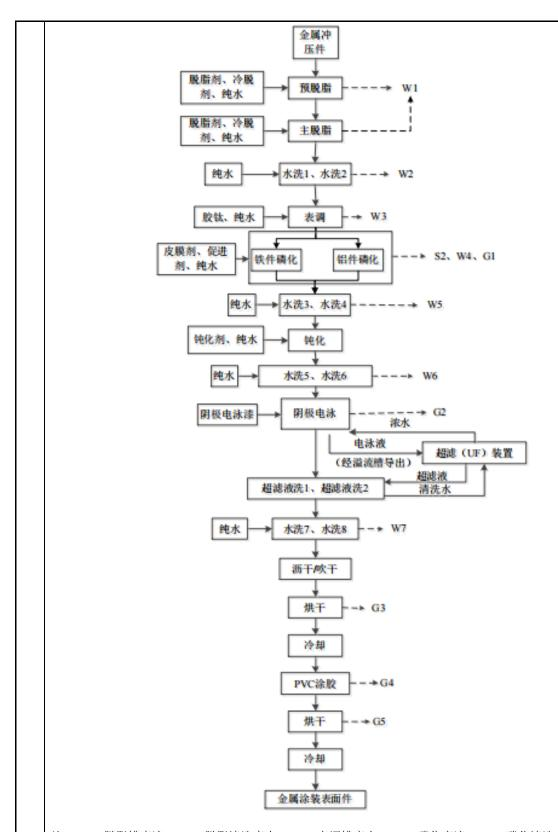
注: W1: 脱脂槽废液、W2: 脱脂清洗废水、W3: 表调槽废水、W4: 磷化废液、W5: 磷化清洗废水、W6: 钝化清洗废液、W7 电泳清洗废液、G1: 磷化废气、G2: 电泳废气、G3: 电泳烘干废气、G4: PVC 喷涂废气、G5: PVC 烘干废气、G6: 锅炉废气、S2: 磷化废渣
